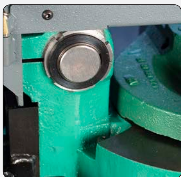
Eccentrico per ottenere una perfetta perpendicolarità
