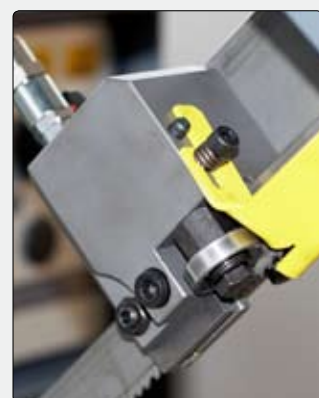
Pattini guidalama con piastrelle in acciaio widia regolabili
