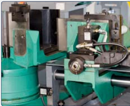
La morsa del carro alimentatore (vista posteriore), comandata idraulicamente, allinea automaticamente il pezzo alle ganasce della morsa di taglio.
