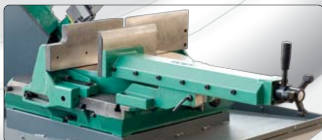
Morsa ad accostamento rapido, posizionabile trasversalmente lungo tutta la base di appoggio e spalle morsa regolabili
