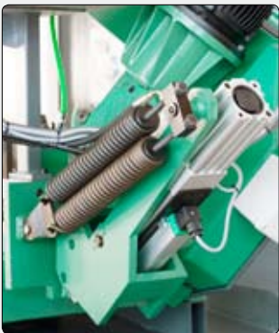
Cilindro idraulico con doppia molla di sicurezza e potenziometro lineare
