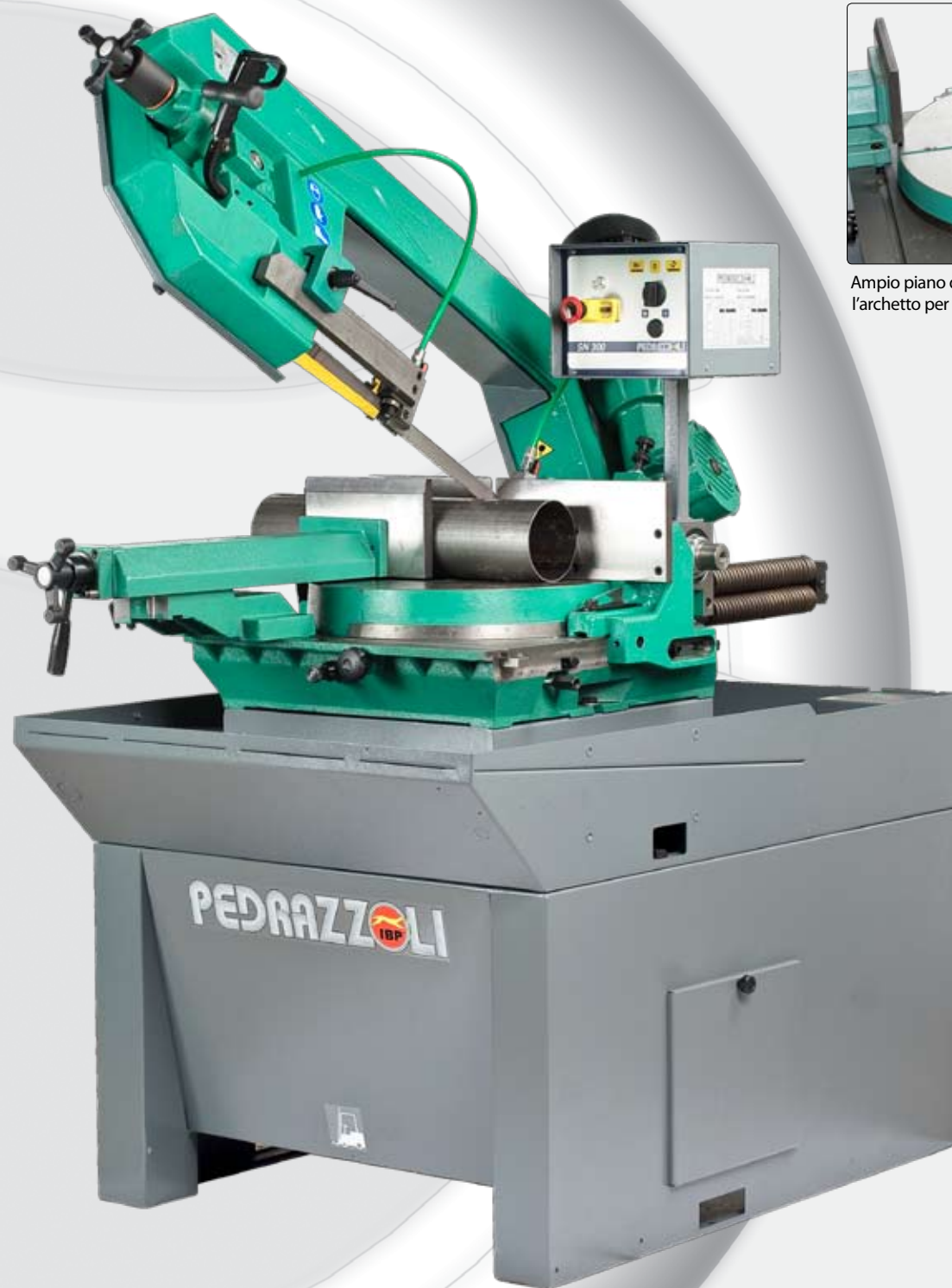
Pattini guidalama con piastrelle in acciaio widia regolabili
