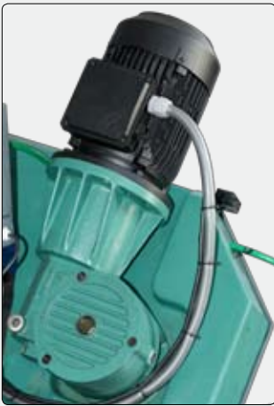
Motore in posizione verticale per ridurre l'ingombro e trasmissione con riduttore 1:40 in bagno d'olio
