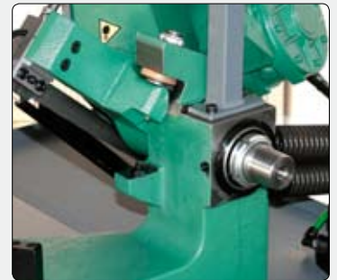
Eccentrico per regolare la perpendicolarità dell'archetto
