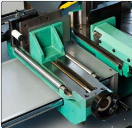
Il carro alimentatore, comandato idraulicamente, è dotato di rulli di scorrimento rettificati e temprati.
