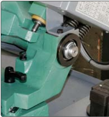
Eccentrico per regolare la perpendicolarità dell'archetto
