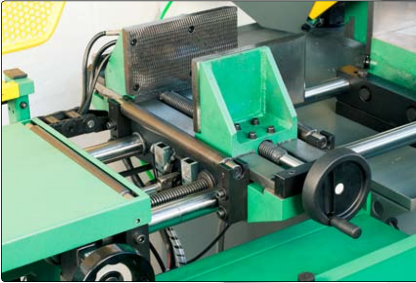
Il carro alimentatore, comandato idraulicamente, è dotato di rulli di scorrimento rettificati e temprati.
